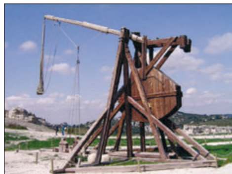
◆ Рис. 4. Требюше біля замку де Бо у Франції. Реконструкція
