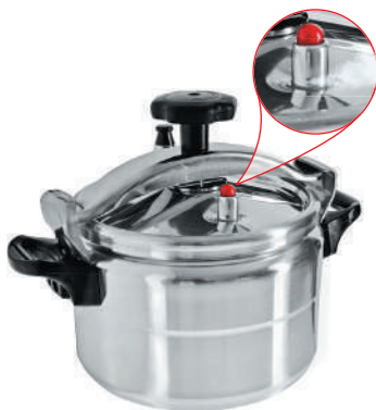
Рис. 14.5. Кастрюля-скороварка: завдяки клапанам і герметичній кришці підтримується високий тиск у просторі над рідиною, тому температура кипіння води в такій кастрюлі становить близько 120\text{ }^{\circ}\text{C}
