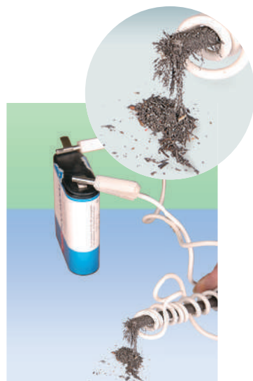
Рис. 24.5. Під час пропускання струму цвях стає магнітом і притягує до себе залізні ошурки
