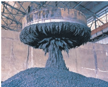
Рис. 6.5. Електромагнітний підймальний кран
