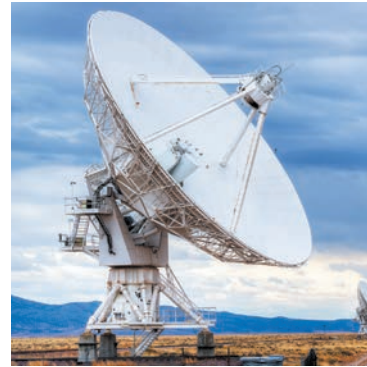
Рис. 21.3. Випромінювання вузького направленого пучка ультракоротких радіохвиль і приймання відбитого сигналу забезпечує параболічна антена радіолокатора
