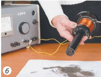
Рис. 6.4. Після замикання кола залізні ошурки притягуються до осердя (а); після розмикання кола — відпадають від нього (б)
