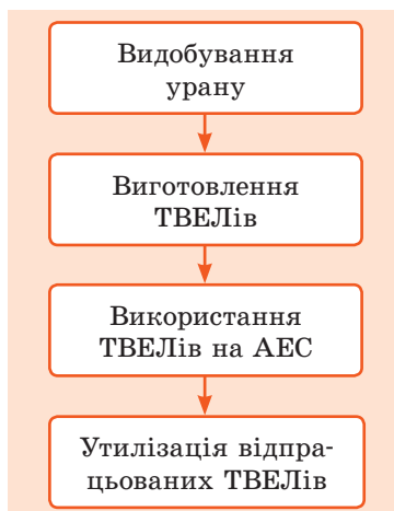
Рис. 27.2. Схема ядерного циклу
