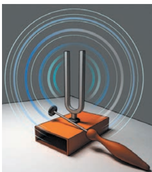
Рис. 18.2. Ніжки камертона коливаються й тому випромінюють звук
