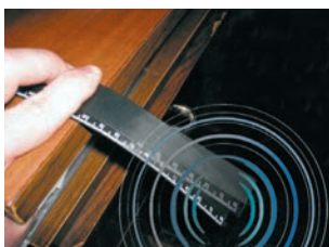
Рис. 18.1. Після того як кінець лінійки буде відпущено, лінійка почне коливатися та випромінювати звук
