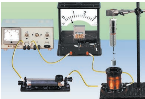
Рис. 6.1. Дослідження магнітної дії котушки зі струмом
