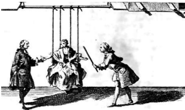
Рис. 40.6. Дослід, що демонструє існування провідників і діелектриків (гравюра середини XVIII ст.). Жінка сидить на гойдалці, підвішеній на шовкових нитках. Чоловік, який стоїть праворуч, наближає наелектризовану скляну паличку до руки жінки, а той, що стоїть ліворуч, торкається до її другої руки — з'являється іскра
