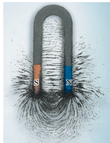
Рис. 2.4. Рисунок, утворений ланцюжками залізнних ошурок, відтворює картину ліній магнітної індукції магнітного поля підковоподібного магніту
