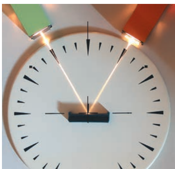
Рис. 11.5. Демонстрація оборотності світлових променів: відбитий промінь іде шляхом падаючого променя
