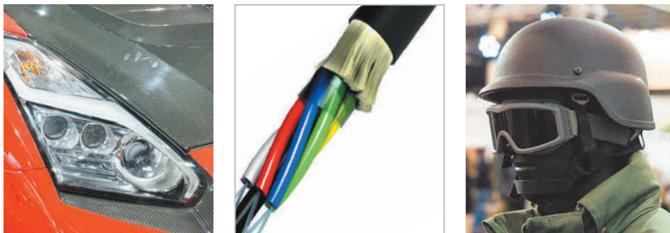
Мал. 35.6. Вироби з кевлару: армувальне покриття деталей автомобіля, кевларовий захист в оптичних кабелях, кевларовий шолом
